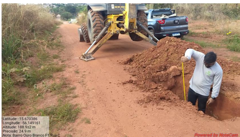
Coleta dos furos de sondagem
